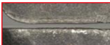
Řezná hrana méně náchylná k tvorbě rýh při obrábění nerezové oceli
